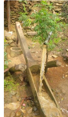
Moulin hydraulique traditionnel Hmông pour égrainer le riz : une fois le récipient rempli d'eau, il s'abaisse et, en reprenant sa position initiale, il pilonne le riz situé dans un bac à l'aide d'un mortier situé à l'autre extrémité du balancier
