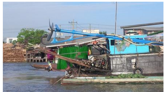
Moteur de bateau à hélice, à refroidissement à eau (voir "l'entonnoir" par lequel l'eau est aspirée par une pompe pour refroidir le moteur)
