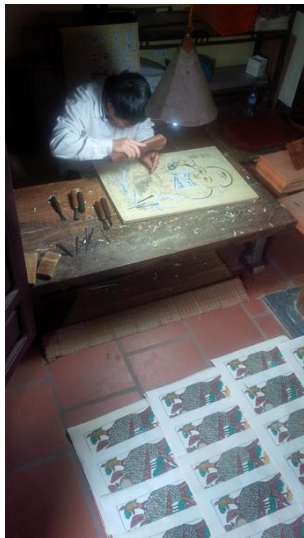
Première étape pour fabriquer une estampe : travail du bois (le graver) pour en faire un moule ou des moules (un par couleur) par estampe
